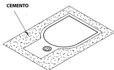
**4.** Nivelar y fijar la base extraíble con cemento.
