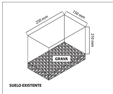
**1.** Realizar agujero para la instalación de la base, preferiblemente con broca de diamante o en su defecto, con martillo neumático o rotatorio. Realizar un drenaje de grava.
